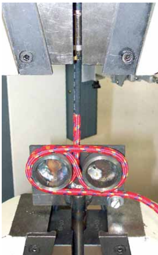
Diese Tortur überlebt kein Testkandidat – die Zugprüfung
